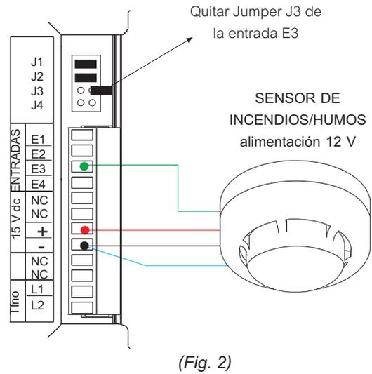
En las figuras de abajo se muestran ejemplos de instalación de varios sensores de presencia y humos adicionales. La fuente de alimentación de aSmart Lite permite alimentar dichos sensores externos hasta un máximo de 6. En todo caso será necesario informarse del consumo de los sensores que se van a instalar con el fin de no sobrepasar el máximo de corriente que la fuente del aSmart suministra (150mA). Si se tuviese alguna duda, la mejor opción es alimentar los sensores con una fuente externa.
